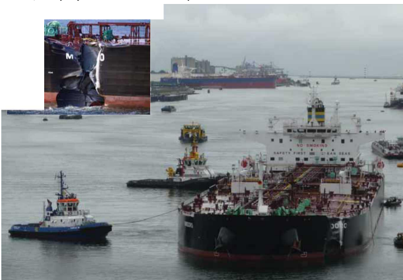
Mindoro doznał dużego uszkodzenia na lewej burcie (patrz zdjęcie)
