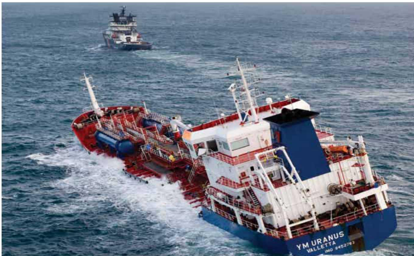
Wypadek YM Uranus ilustruje jak podwójny kadłub pomaga zapobiegać potencjalnym poważnym wypadkom zanieczyszczenia morza
